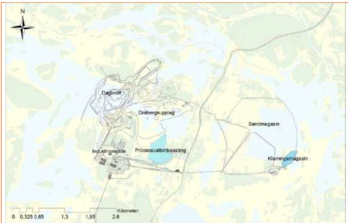
Figur 1. Verksamheten omfattas av dagbrott, gråbergssupplag, industriområde med anriktningsverk, processvattendamm, sandmagasin samt klarningsmagasin.
