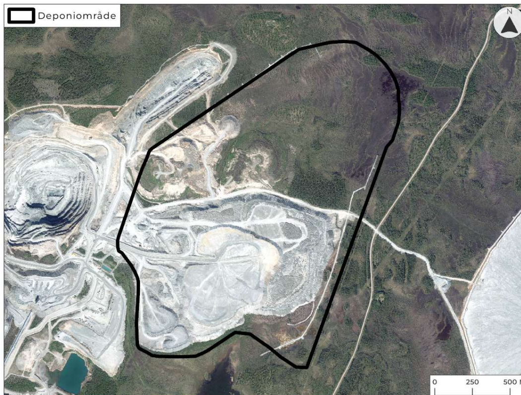
Figur 4 Nuvarande utbredning av Tapuli gråbergsdeponi inom tillståndsgivet deponiområde, svart linje. I dagsläget används till största delen det södra upplaget. I takt med fortsatt brytning av Tapuli och Palotieva dagbrott kommer det norra upplaget att användas.
