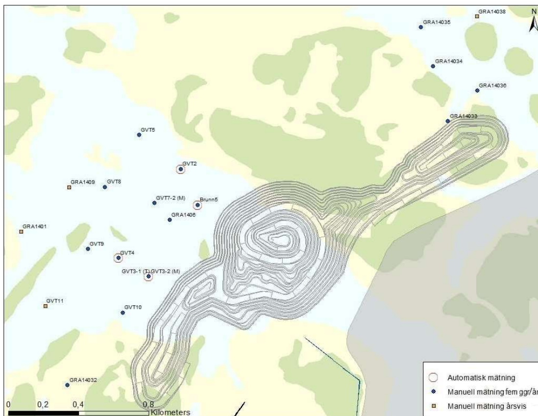
Figur 7. Lokalisering av mätpunkter för grundvattennivå på myrmark som omger dagbrottet i nordväst. Vissa grundvattenrör mäts fem gånger per år medan andra mäts manuellt på årsbasis. Fyra av rören mäts dessutom kontinuerligt med automatiska mätstationer.
