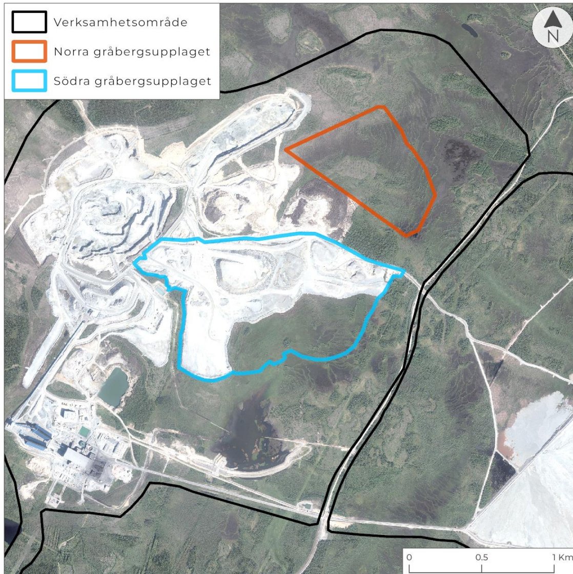
Figur 4. Nuvarande utbredning av Tapuli gråbergsdeponi, blå linje. I dagsläget används enbart den södra deponin. I takt med fortsatt och utökad brytning av Tapuli och Palotieva dagbrott kommer den norra deponin att öppna upp för deponering av gråberg under våren 2024.
